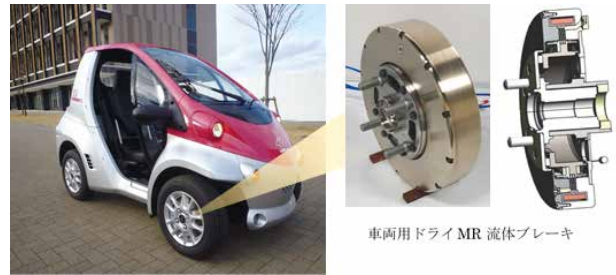
図14 四輪にドライMR流体ブレーキを実装した小型EV
