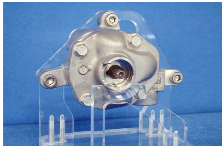
写真② フローコントロールバルブを廃止した新型ベーンポンプ外観
