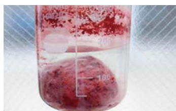
塗料カスと水分を分離し、水分は適正な処理をして放流する。
