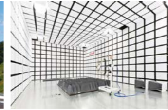
電子技術センター 電波暗室内
