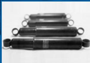
航空機用油圧緩衝脚「オレオ」のメカニズムを応用し開発した筒型ショックアブソーバは、当時の主流品よりコスト・耐久性・走行性で優れた性能を示し、生産拡大する国内自動車メーカーに多く採用されました。国産乗用車の性能向上の一翼を担いました。
