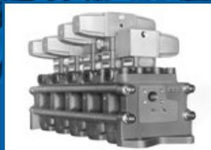
油圧システムのさらなる高度化やコンポーネント化を見据えて、心臓部にあたる制御装置のコンパクト化に成功。既存の大きく複雑な配管を一新。「油圧バルブの革命児」といわれ、KYBが産業油圧機器分野へ進出する足掛かりとなりました。
