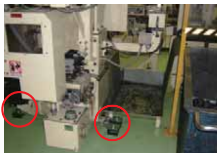
機械の地震対策（岐阜北工場）
