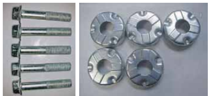
ELV規制対応のショックアブソーバ用部品 (6価→3価クロムに変更)
