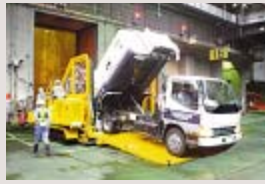
自走式コンベアごみ投入検査機
