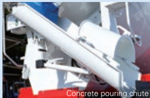
Concrete pouring chute
