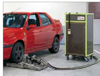
異音再現装置「マクノックス」 "MCNOCS" Reproduction Device to Probe for In-car Abnormal Noise
