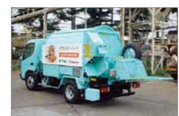
剪定枝粉砕処理車「タウンビーバー」 "Town Beaver" Chipping Vehicle for Pruned Branches
