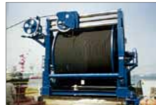
ケーブルストアウインチ Cable Storing Winch
