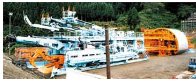
トンネルワークステーション Multi-functional Whole Profile Excavator : TWS (Tunnel Work Station)
