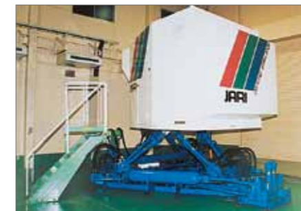
ドライビングシミュレータ [日本自動車研究所] Driving Simulator System : JARI
