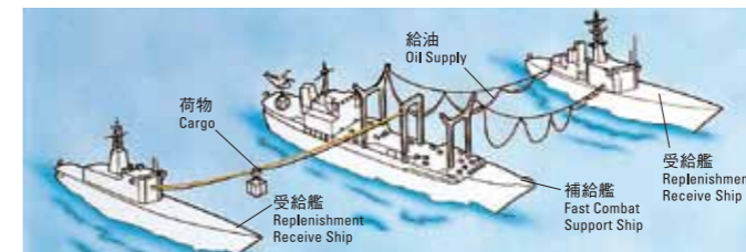
「ましゅう」(中央)から両側の護衛艦へ補給している状況の説明図 This picture Shows That Materials are Supplied from MASYUU (center) to Two Destroyers on Both Sides.
