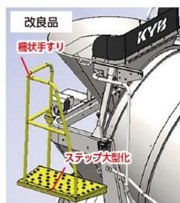
図2. 上段ステップ、手すりの改良
