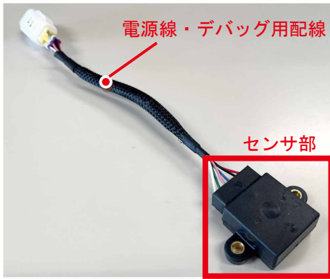
写真2 Bluetooth加速度センサ外観図
