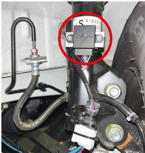
写真3 Bluetooth加速度センサ取付図
