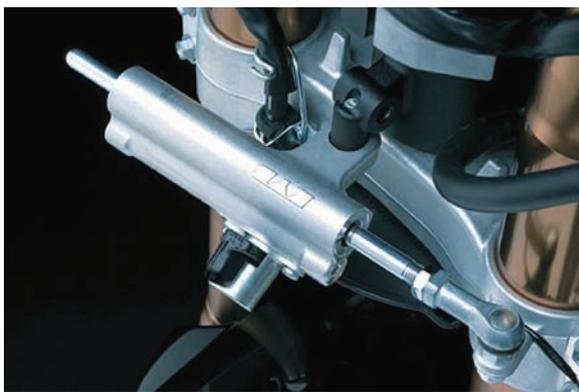
写真4 レシプロ式電子制御ステアリングダンパ<sup>5)</sup>
