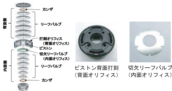
図12 ピストンバルブ構造
