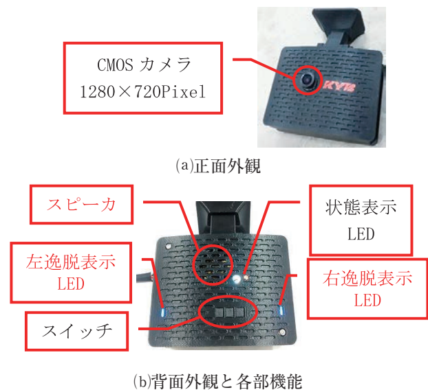
写真1 車線逸脱警報装置の原理試作機
