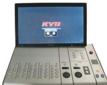
写真1 舞台機構操作卓（K-compo SystemM）
