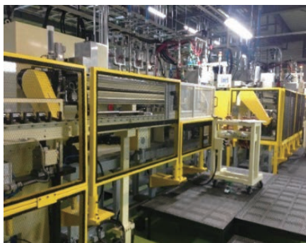
写真8 高周波焼入れ焼戻し設備
