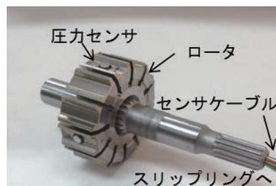
写真1 内圧計測用センサ
