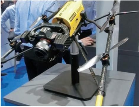
写真4 測量用ドローン
