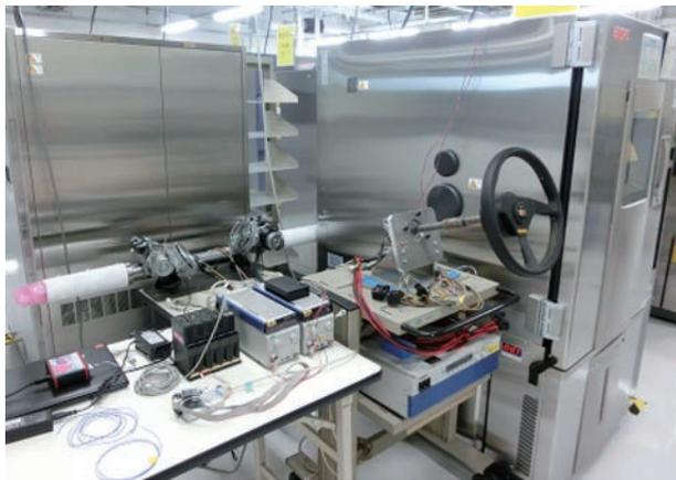
写真7 ECU低温時動作確認試験
