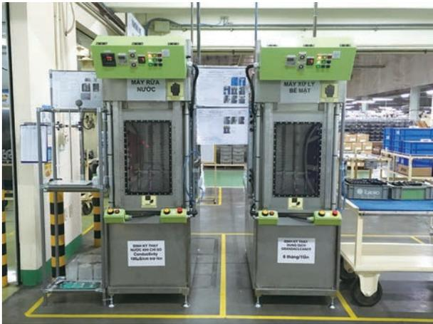
写真13 前処理洗浄機 (右:前処理, 左:水洗)
