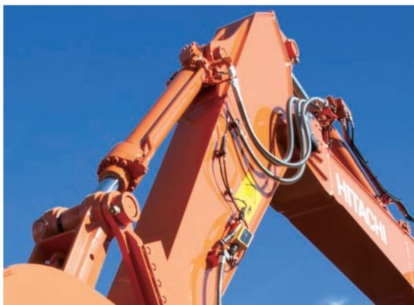
図6 開発品ストロークセンシングシリンダ
