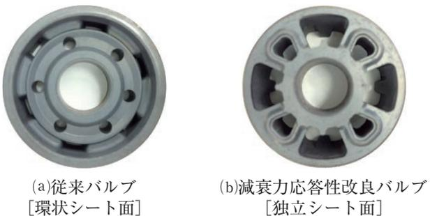
図1 ピストン内面側シート面形状
