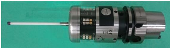
写真2 機内自動計測装置
