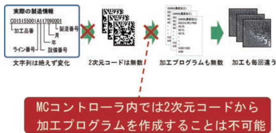
図7 2次元コードの加工プログラム変換
