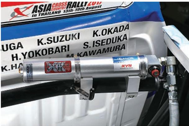
写真7 アルミ材を採用した大型リザーバタンク
