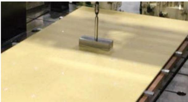
写真5 天井静的破壊荷重測定
