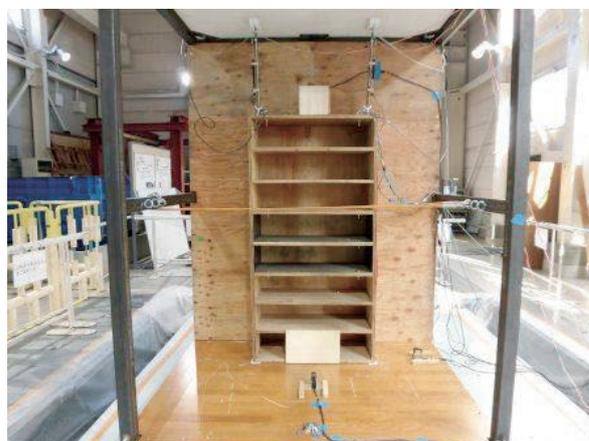
写真2 3軸振動台実験状態
