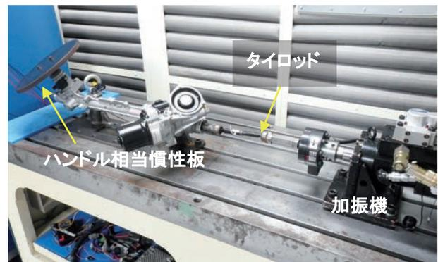
写真6 異音評価試験機
