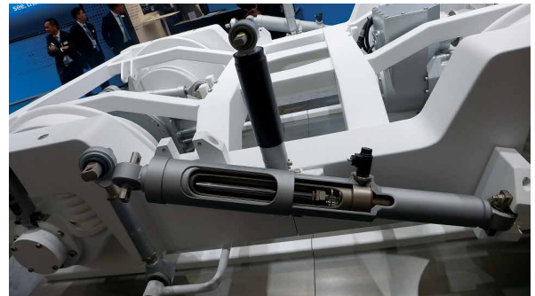
写真10 外付式三重管セミアクティブダンパ
