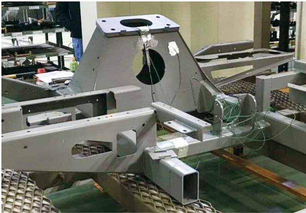
写真6 物温 (フロントフレーム) 測定実施例
