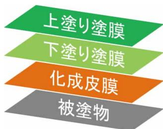
図1 2コート塗膜のイメージ図
