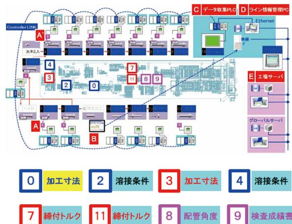
図5 V5ラインネットワークと収集データ
