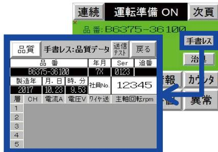
図9 溶接機 操作盤加工条件データ
