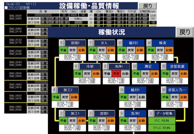
図11 データ収集PLC操作盤表示画面
