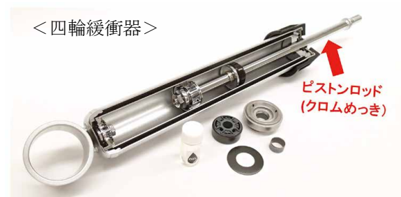
写真1 硬質クロムめっきを施している製品
