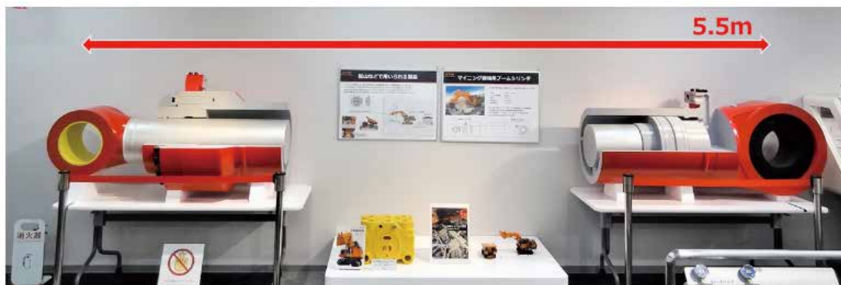
写真10 マイニングショベルのブームシリンダ実物大模型
