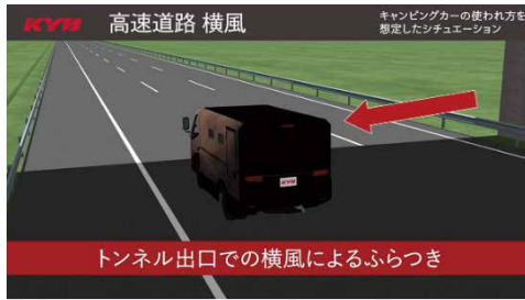
図2 トンネル出口での横風影響
