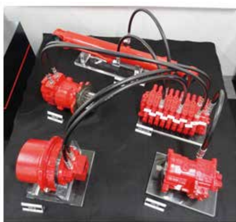
写真9 ミニショベル油圧システムセット
