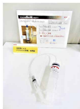
写真7 大小注射器によるパスカルの原理体験
