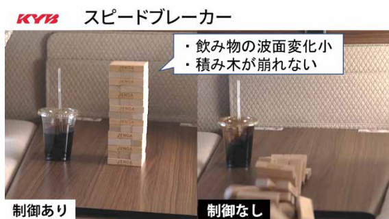
写真7 スピードブレーカーでの比較（室内）
