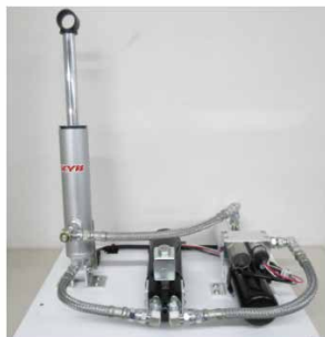
写真2 車高調整システム外観
