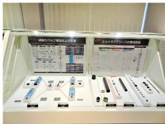
写真12 SA分解展示、バルブ部の説明
