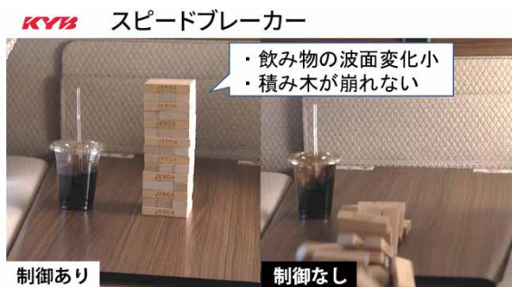
写真7 スピードブレーカーでの比較（室内）
